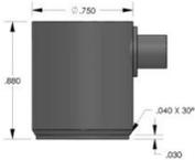
F15a - Sensor AE de respuesta de frecuencia plana de alta sensibilidad de 100-450 kHz
