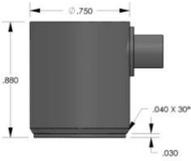
F15a - Sensor AE de respuesta de frecuencia plana de alta sensibilidad de 100-450 kHz
