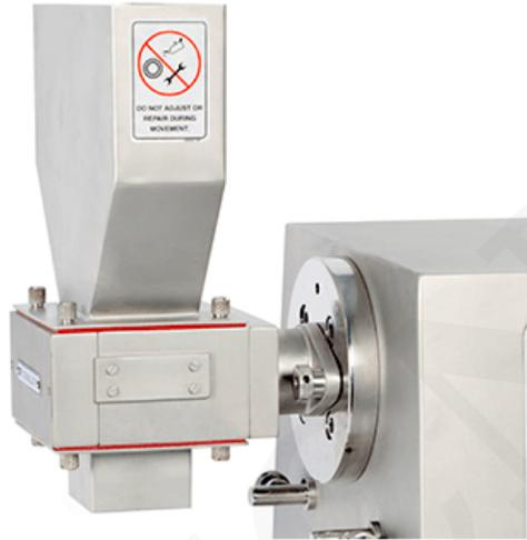
Ideal para granular tabletas y gránulos. El granulador en seco consta de dos rodillos motorizados con fuerza de dientes. Esto obliga al material a granular con una proporción muy baja de polvo. Babosas duras de 2 a 2,5 mm de espesor se obtendrán la siguiente granulación, 50% de malla 16, 25% de malla 24, 10% de malla 70 y 20% del polvo.
