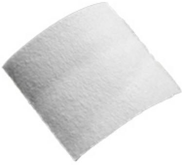
El aerogel tiene una de las conductividades térmicas más bajas conocidas por los sólidos. Se seleccionó una manta de aerogel de elección para probar con el medidor de flujo de calor. Los resultados concluyeron una conductividad térmica de **0,014 W/m•K**, que está dentro del 3% de las especificaciones del fabricante.
