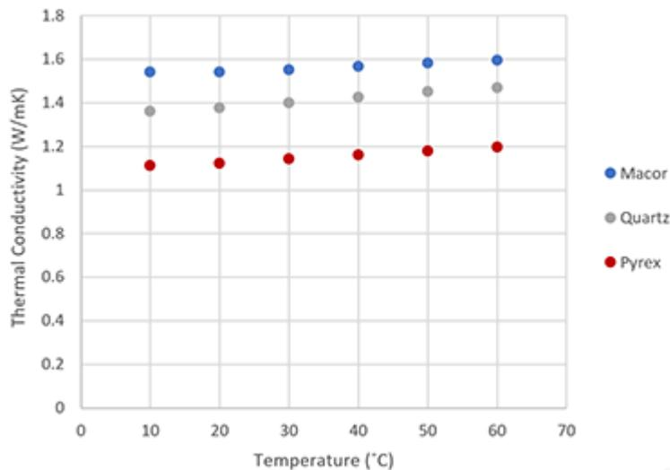
Con el kit de alta conductividad térmica adicional, los HFM-100 / HFM-50 pueden medir de manera precisa y eficiente materiales de mayor conductividad térmica, como vidrio y cerámica. Para tales aplicaciones, se utiliza un kit de termopar externo en combinación con la muestra que se está probando. Macor, Quartz y Pyrex se probaron en el HFM de 10 °C a 60 °C (50 °F a 140 °F). Todos los valores medidos están dentro de la precisión declarada del sistema,  $\pm 5\%$ .
