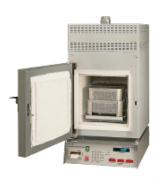
El horno de contenido de asfalto (horno NCAT) determina automáticamente el contenido de asfalto de las mezclas de pavimentación. Desarrollado por NCAT, el Centro Nacional de Tecnología del Asfalto, este horno es un método rentable y respetuoso con el medio ambiente para la determinación precisa del contenido de asfalto. Elimina los problemas de costo y seguridad que conlleva el uso de solventes y la eliminación de solventes plagada de otros métodos.
