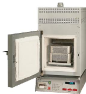
El horno de contenido de asfalto (horno NCAT) determina automáticamente el contenido de asfalto de las mezclas de pavimentación. Desarrollado por NCAT, el Centro Nacional de Tecnología del Asfalto, este horno es un método rentable y respetuoso con el medio ambiente para la determinación precisa del contenido de asfalto. Elimina los problemas de costo y seguridad que conlleva el uso de solventes y la eliminación de solventes plagada de otros métodos.
