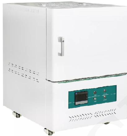
Se utiliza para sinterizar, fundir y analizar metales, no metales y otros materiales compuestos en laboratorios de universidades, institutos de investigación y empresas industriales y mineras.
