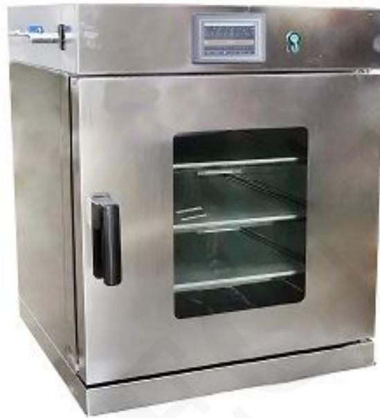
Está diseñado para secar las sustancias sensibles al calor, fácilmente descompuestas y fáciles oxidadas. Es ampliamente utilizado en medicina, alimentos, industria ligera, industria química, investigación científica agrícola, protección ambiental y otros campos experimentales.
