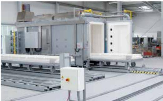
Horno combinado, compuesto por un horno de solera móvil WB 11000/HS, sistema de desplazamiento de soleras y dos soleras móviles adicionales incl. los rieles de estacionamiento necesarios
