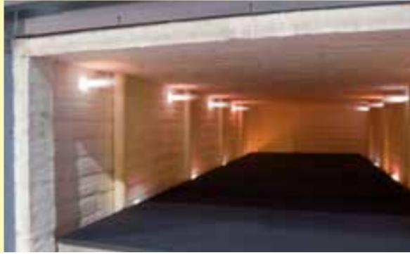
Cámara interna del horno con ocho quemadores de alta velocidad
