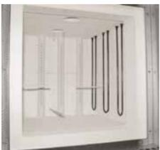
Inyección de aire fresco a través de tubos perforados
