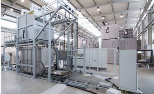
**Horno de apertura inferior totalmente automático con baño de agua móvil incl. puesto de estacionamiento para cargar y grúa de descarga**
