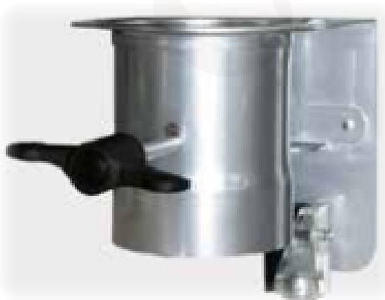
Válvula de entrada de aire semiautomática para el secado residual en hornos de cámara de hasta 300 litros. La válvula se cierra automáticamente a una temperatura predeterminada. Se elimina el cierre manual de la entrada de aire tras la fase
