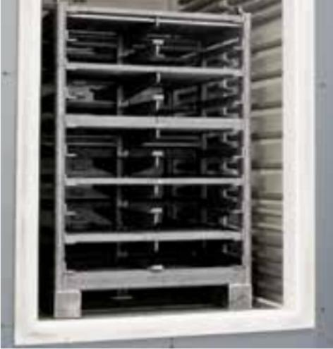
Bastidor de carga para horno de cámara N 2200
