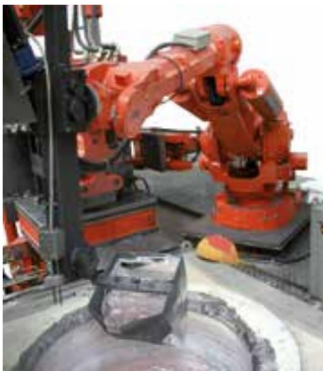
**Extracción de un T 650/10 con robot de cazo**
