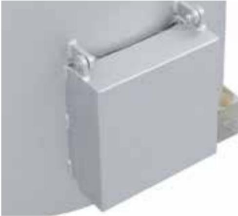
Salida de emergencia para desviar la masa fundida de forma segura en caso de rotura del crisol
