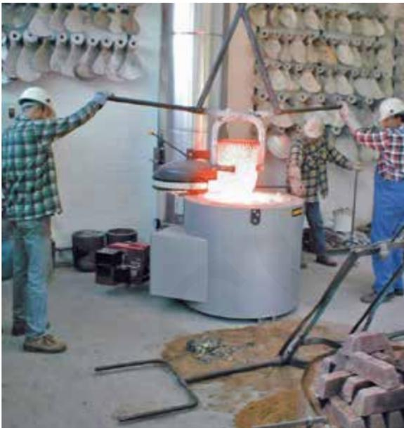
Horno de cazo TB20/14 para fundición de bronce con salida lateral de gases y placa de collar giratoria para extracción del crisol
