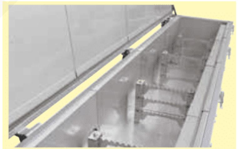
Apoyo de carga para tubos largos en un horno tipo arcón
