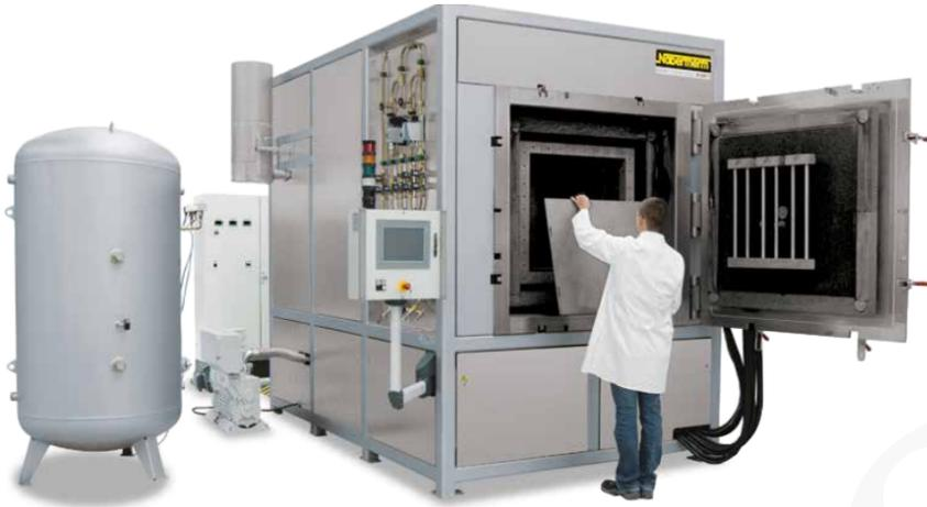
Horno de retorta VHT 500/22-GR H<sub>2</sub> con recipiente de proceso CFC
