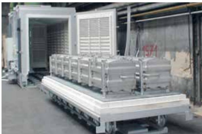
Horno de vagoneta por carretilla con sistema de gasificación
