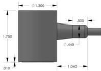
ISPKWDIUC - Sensor AE submarino diferencial de 100-800 kHz
