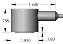
ISR30CA-HT - Sensor AE intrínsecamente seguro de 300 kHz con cable coaxial integral
