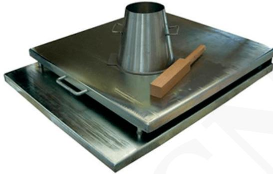
El equipo de prueba se utiliza para mezclas de hormigón de alto trabajo. La prueba determina el índice de flujo como una media aritmética del diámetro de la muestra después de trabajar en una mesa de flujo.
