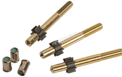
Cada kit de sonda certificado incluye 3 sondas y 3 cargas de potencia acopladas, niqueladas. El kit de sonda de plata es para piedra natural o agregado grueso (densidad superior a 125 lbs / pies cúbicos). El kit de sonda de oro es para agregado liviano (menos de 125 lbs / pies cúbicos de densidad).
