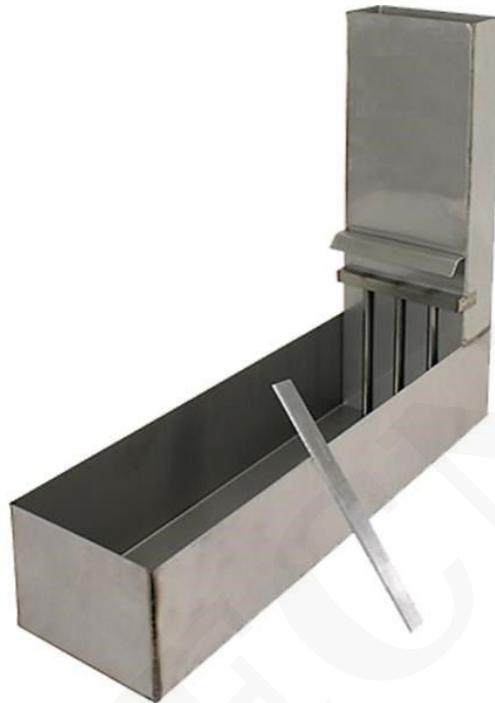
La caja en forma de L se utiliza para evaluar la capacidad autocompactante (capacidad de flujo confinado) del concreto autocompactante recién mezclado.
