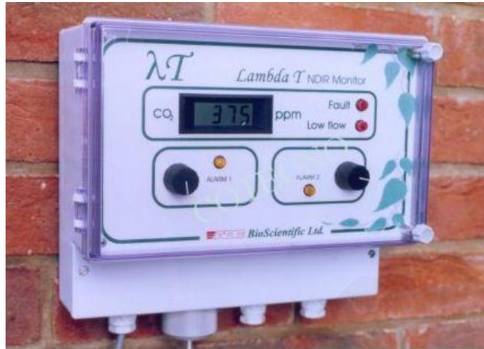
El Lambda T es un monitor de alta precisión de CO<sub>2</sub> que emplea una técnica de longitud de onda doble, no dispersiva, infra-roja y óptica. Este sistema de detección asegura que el monitor es un gas específico y mantiene la estabilidad de calibración a largo plazo.
