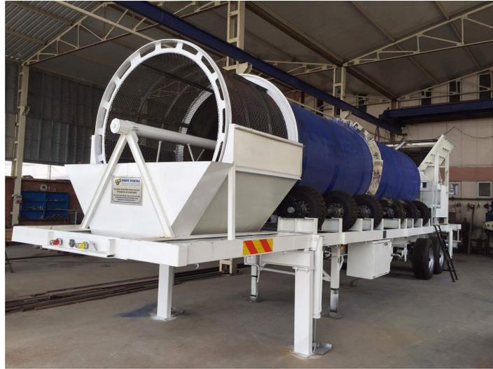
Gracias al sistema de tamizado y lavado de nuestra instalación móvil de lavado utilizada en la zona de lavado de la mina, se lava fácilmente la tierra sucia de la mina o del barro y se separa con los tamices de una o dos capas del extremo. Debido a que se instala en el remolque, se puede transportar fácilmente con la ayuda de un tractor y puede trabajar donde se desee. Tiene muchas áreas de aplicación, especialmente en los minerales de oro, magnesita y hierro.
