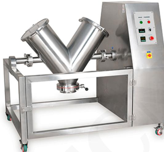
La licuadora en V (R&D), se utiliza para producir una mezcla sólida y homogénea. La mezcla es un paso del proceso común en la fabricación de productos para industrias como la salud, farmacéutica, alimentaria, química, cosmética, detergentes, colorantes, fertilizantes y plásticos.
