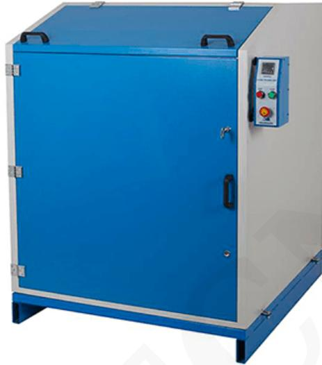
La máquina está equipada con un contador automático, que permite detenerse cuando se completa el número preestablecido de revoluciones. Se suministra una bandeja con la máquina para facilitar la descarga de la muestra.
