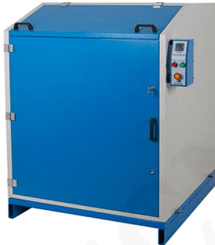
La máquina de abrasión de los ángeles se utiliza para determinar la resistencia de los agregados a la fragmentación. La máquina consta de una unidad de control electrónico y un tambor de acero laminado que tiene un diámetro interior de  $(711 \pm 5)$  mm y una longitud interior  $(508 \pm 5)$  mm. El tambor gira a una velocidad de entre 31 y 33 r.p.m.
