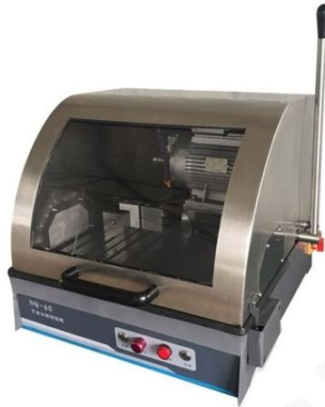
La máquina puede cortar las muestras de materiales metálicos y no metálicos, para observar la estructura metalográfica y petrográfica de los materiales.
