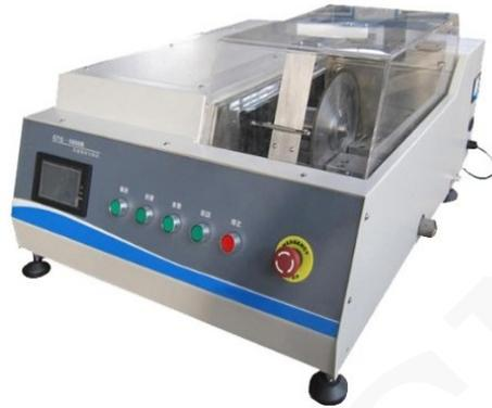
El nuevo modelo de máquina de corte de precisión de muestras metalográficas Bell-MaqCortPMM-5000B presenta potentes funciones y un rendimiento estable.
