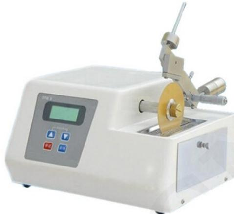
La máquina de corte de precisión de muestras metalográficas de baja velocidad modelo Bell-MaqCortPMM-5 es adecuada para el corte preciso de varios materiales duros.
