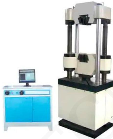
Máquina de ensayo de tracción universal 30t - Marca Belltronic
