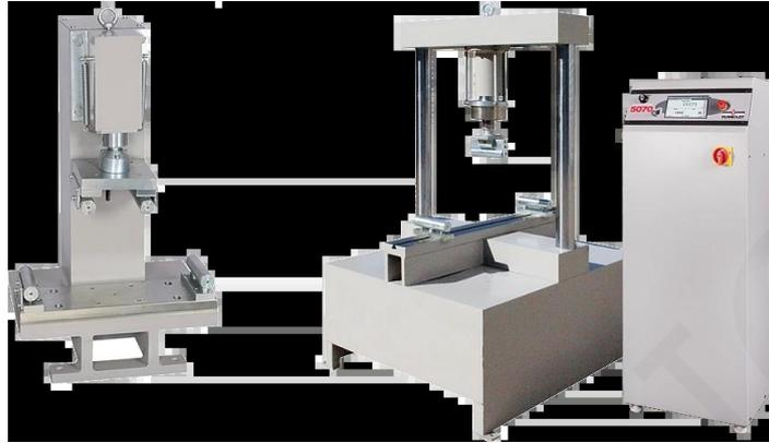
Estos marcos de la serie Flexural están diseñados para usarse como marcos auxiliares junto con una máquina de compresión de concreto controlada por los sistemas de control y bomba automática HCM-5080 o HCM-5070 de Humboldt. Consulte las páginas 199 -200 para obtener más información sobre los sistemas de control y bombas automáticas de Humboldt.
