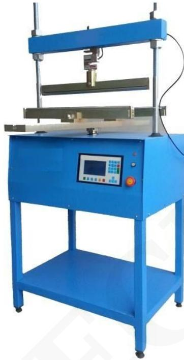
Máquina de prueba de flexión electromecánica puede probar la tensión de flexión de diferentes tipos de materiales.
