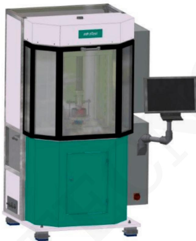
Sistema dinámico compacto para la determinación de pruebas de rigidez y fatiga en suelos y mezclas asfálticas. 25/30 kN con actuador hidráulico y sistema de medición de carga y desplazamiento. La cámara climática es incluido y preparado para el uso de diferentes marcos como la tensión indirecta, la prueba dinámica de fluencia, etc.
