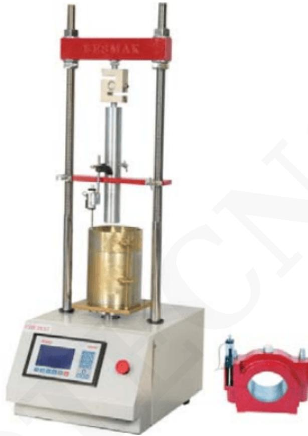
La máquina de ensayos CBR-MARSHALL de 50 kN de capacidad está desarrollada para realizar ambos ensayos en un marco. Reduce los costes para los clientes. La viga superior se puede ajustar en altura. Fácil de cambiar aparato según las pruebas CBR o Marshall.
