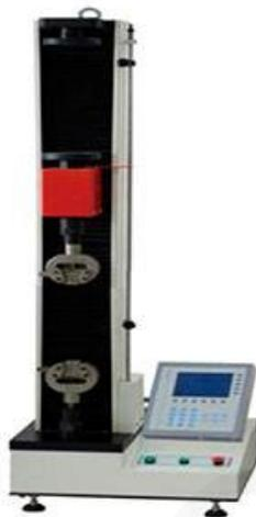
Es aplicable para una amplia gama de materiales para tensión, compresión, flexión, cizallamiento y ciclo bajoprueba. Adecuado para pruebas de metales, caucho, plástico, resortes, textiles y componentes.
