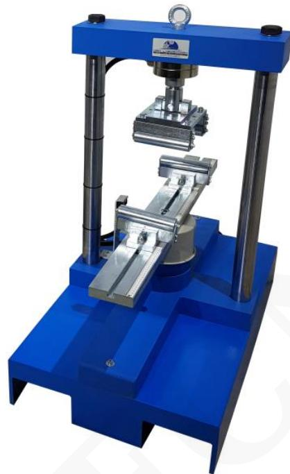
**SKU:** N / A | **Categorías:** [Maquinas de pruebas de compresion](#) | **Etiquetas:** [12390-5](#), [12390-6](#), [1340](#), [ASTM C293](#), [ASTM C496](#), [ASTM C78](#), [BS 1881](#), [EN 1338](#)
