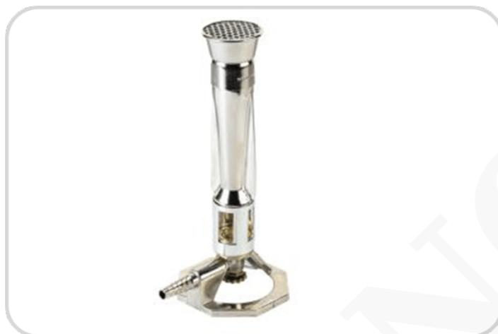
Tubo Venturi de quemador de alta temperatura, Meker Top, Gas natural, 1-1 / 2 "(38 mm), diámetro exterior del tubo mezclador, 12.5 CFH, 12.810 BTU de salida, 8-1 / 2" (216 mm) de altura total
