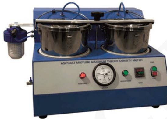
Medidor de densidad teórica máxima, para las mezclas de asfalto utilizado para determinar la gravedad específica máxima teórica de las mezclas de pavimento bituminoso no compactadas por proceso de vacío
