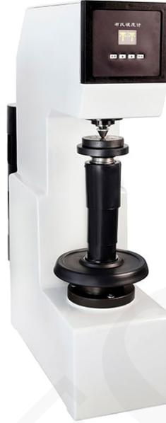
Se utiliza principalmente para determinar la dureza del hierro fundido, el acero, los metales no ferrosos y las aleaciones blandas, y también puede ser
