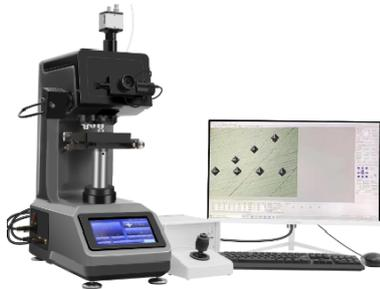
Durante la prueba, el penetrador y la lente del objetivo cambian automáticamente entre sí, y el punto de prueba se localiza automáticamente con precisión.
