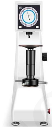
Durómetro superficial adecuado para medir la dureza superficial de los metales ferrosos, aceros aleados, carburos y metales después de haber sido tratados (carburación, nitruración, capa de revestimiento). Especialmente adecuado para medición de precisión de planos paralelos.
