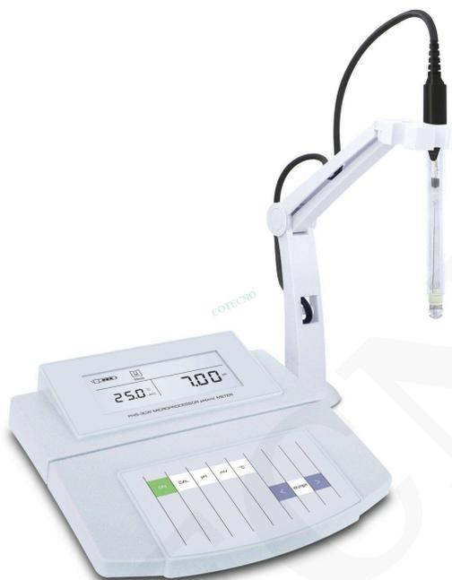
El medidor de pH estándar, cuenta con una calibración de 2 puntos, y compensación automática de la temperatura. El medidor es adecuado para pruebas y controles diarios, así como para aplicaciones en el campo educativo. Precisión: 0.01pH.
