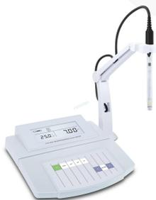
BellMPhm - 1 \*Rango de pH: 0.00~14.00pH \*Precisión del pH:  $\pm 0.05$ pH
