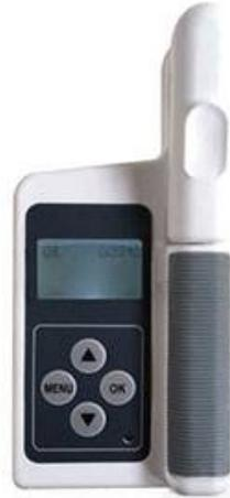
El medidor de clorofila puede medir el contenido de clorofila de las plantas y la temperatura de las hojas. El contenido de clorofila y el contenido de nitrógeno de las hojas tienen una relación muy estrecha. Por lo tanto, el contenido de clorofila puede reflejar la demanda de nitrógeno de las plantas. El uso del instrumento puede ir a poner fertilizante de nitrógeno de manera razonable, mejorar la utilización del nitrógeno y proteger el medio ambiente.
