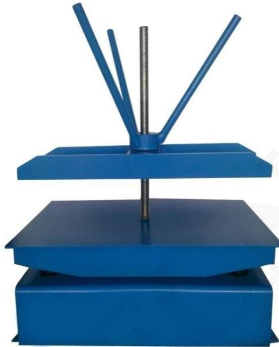
Equipado con motor-vibrador de 3000 vibraciones-minuto, es posible variar la intensidad de vibración actuando sobre las masas excéntricas.
