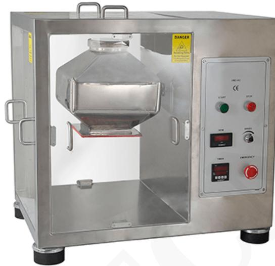
El mezclador octogonal se puede conectar y desconectar fácil y rápidamente al accionamiento principal de la máquina con la ayuda de un tornillo de bloqueo y desbloqueo rápido y cuenta con un 1 HP, 230 V / 110 V, 50 Hz / 60Hz, monofásico con ACVF DRIVE instalado.
