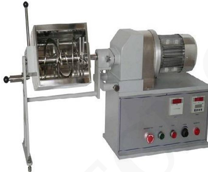
Este accesorio se monta en un soporte de diseño especial. La mezcladora eléctrica [de cinta] tiene un recipiente semicircular horizontal abierto en la parte superior con una tapa superior hermética al vacío y una cuchilla mezcladora especialmente diseñada que tiene dos etapas, ambas a la derecha y a la izquierda. El recipiente se puede entregar con doble chaqueta para enfriar o calentar con agua o sistema de calefacción eléctrica.
