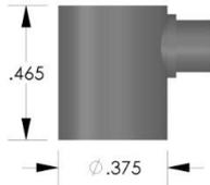
Micro80 - Sensor AE miniatura de 200-900 kHz
