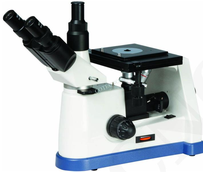
El microscopio metalúrgico Bello-MicMetInv-1 se usa ampliamente en el análisis de estructuras metalúrgicas para la industria mecánica y en el análisis de investigación de minerales del departamento de recursos minerales de geología, y en la observación y medición de cristales, circuitos integrados, microelectrónica de la industria electrónica.
