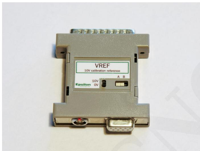
VREF funciona con los extensómetros capacitivos de alta temperatura Modelo 3648 de Epsilon y es compatible con los acondicionadores de señal 3603 y 3604. La referencia de 10 V de alta precisión utilizada en el módulo VREF garantiza que las calibraciones sean precisas en todo momento. Se puede usar un módulo VREF para calibrar varios extensómetros de salida de alto nivel utilizando el valor de extensión de 10V para cada extensómetro.
